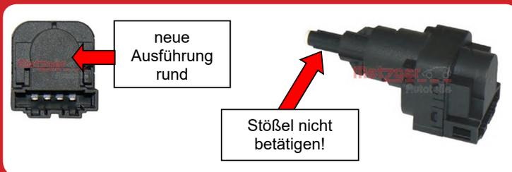
**Achtung:** Dieser Schalter hat einen inneren Mechanismus der durch nicht korrekten Einbau oder falsche Anpassung beschädigt werden kann!
